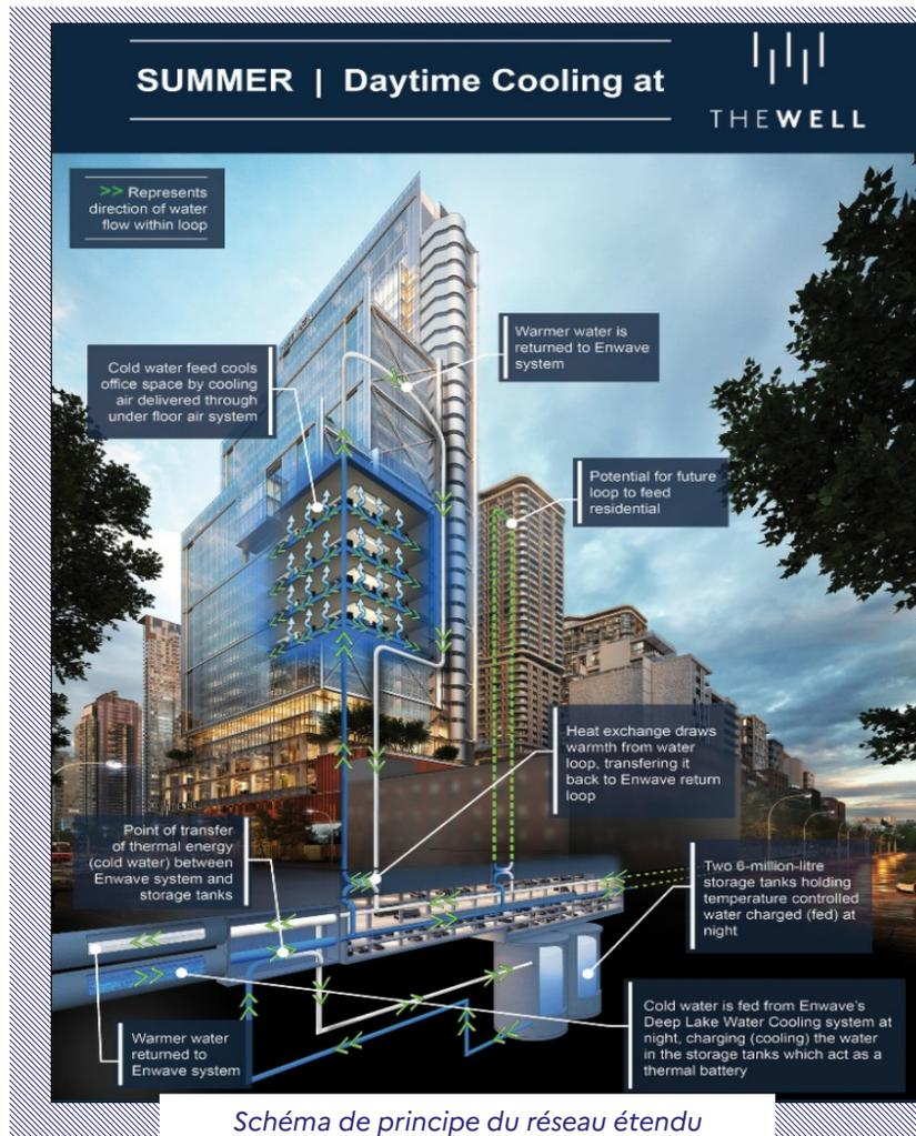
Schéma de principe du réseau étendu d'Enwave
