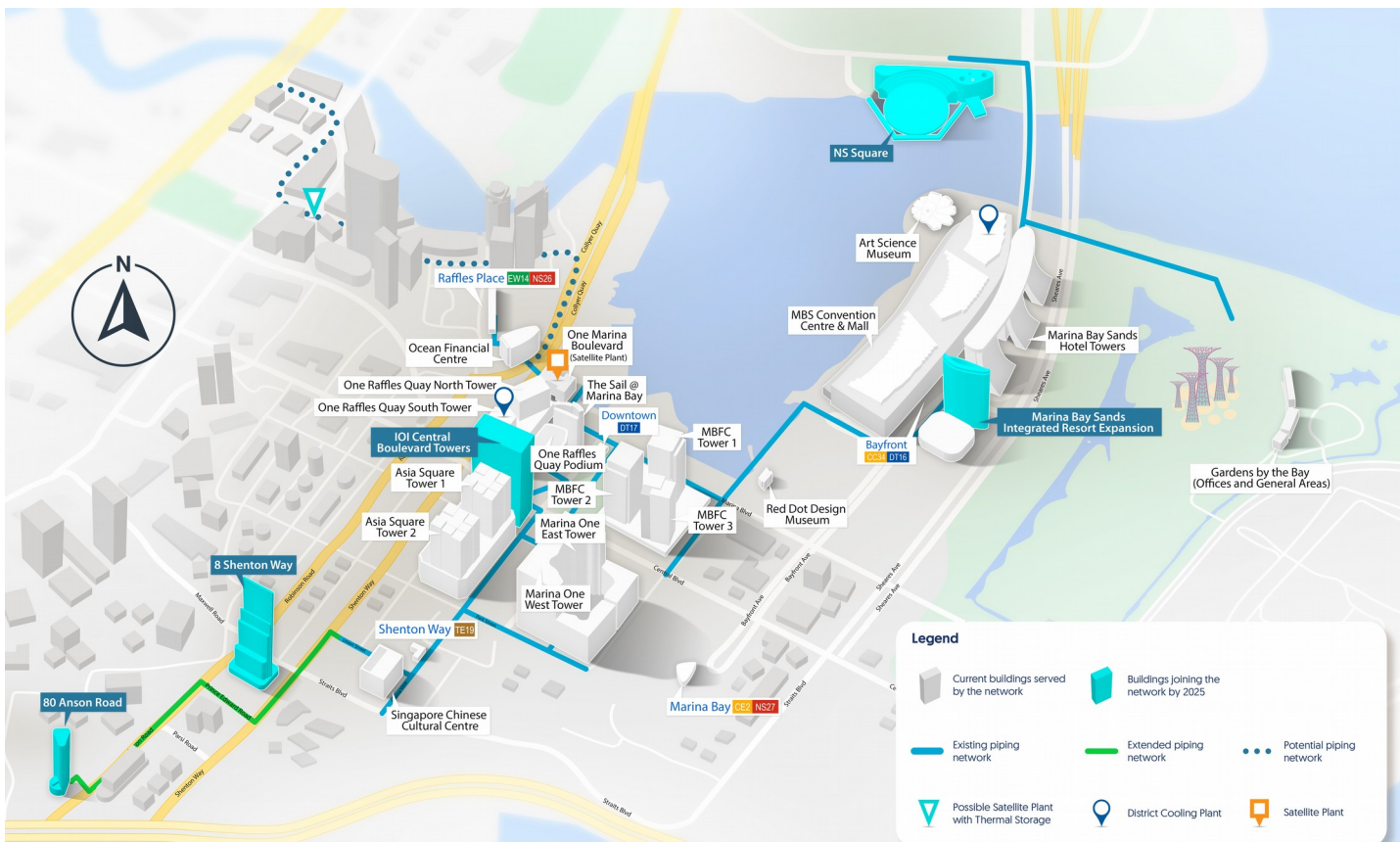
Le projet d'extension du réseau de froid de Marina Bay Source : SP Group
