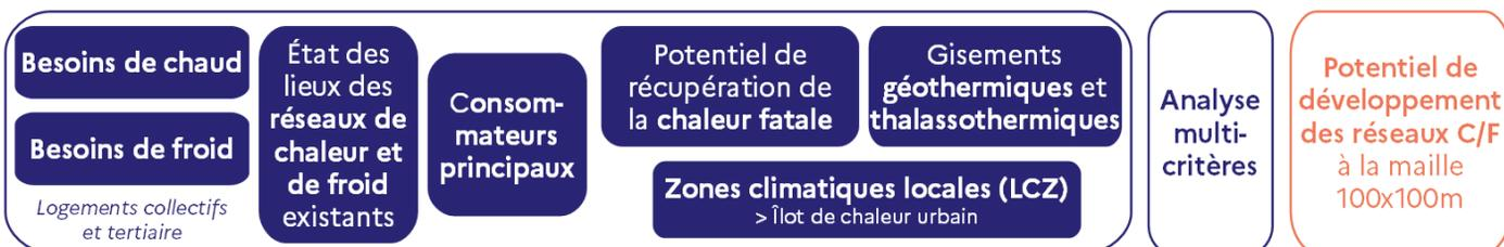
Principe schématisé de la méthode de constitution de l'outil « Potentiel RCF »
