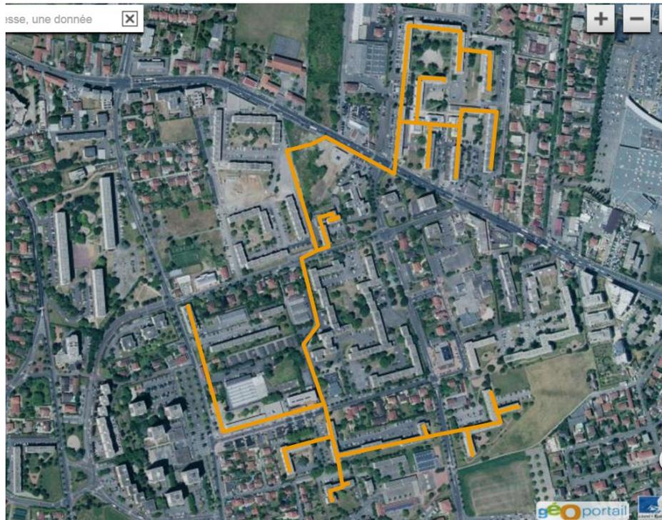
Figure2 : Tracé du réseau (pas de tracé sous la ZAC car la disposition des bâtiments est modifiée)
