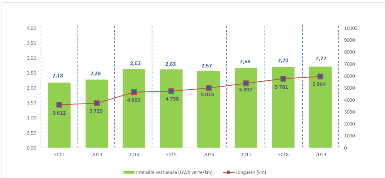
Figure 38 : Évolution de l'intensité vertueuse des réseaux de chaleur entre 2012 et 2019
