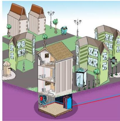
Figure 25 : Représentation d'une sous-station (source : Via Sèva)
